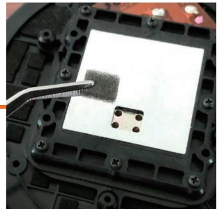
RP ドライバー・ユニットの取付、専用チューニング・ダンパーの取り付け
