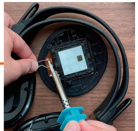
方式を選択するハウジング用チューニングシートの選択・取り付け、RP ドライバーユニットのはんだ付け
